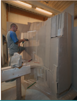
Umsetzung des Modells in eine Holzform
