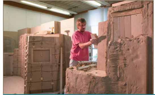
Auftragen der Tonschicht
