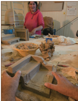
Fertigstellen der Kacheln
